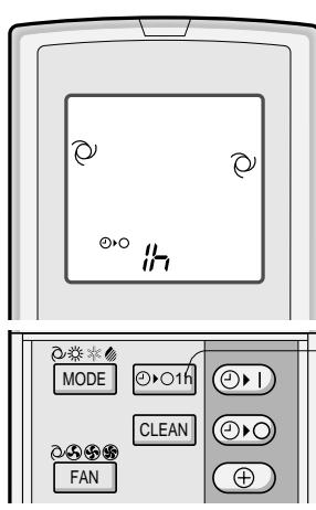
1 Нажмите кнопку ТАЙМЕРА ОТКЛЮЧЕНИЯ ЧЕРЕЗ ЧАС.
