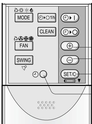
**1** Для того, чтобы выбрать 12-и часовой режим часов, нажмите кнопку ЧАСОВ один раз в первой последовательности.
